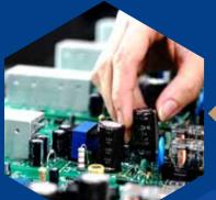
DIP Board Assembly | مونتــــــاژ برد DIP
